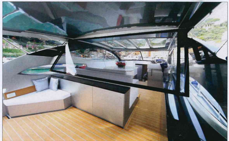
Une baie vitrée escamotable sépare le cockpit arrière de la timonerie. Un choix intéressant permettant d'isoler la partie habitable de l'extérieur.
