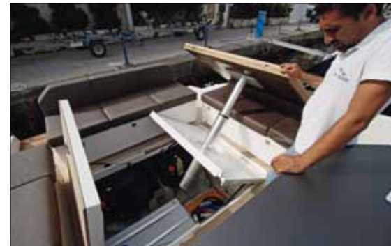
La soute moteur est placée sous la table à pied télescopique, qui sert aussi de plancher lorsqu'elle est baissée.
