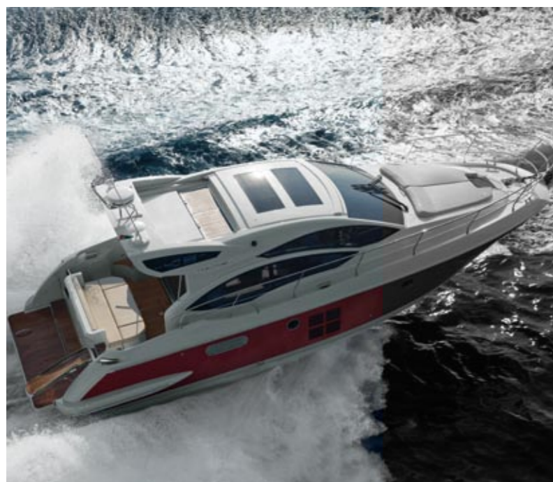
Azimut 40S Lunghezza f.t. 12,02 m Larghezza 4,09 m Motorizzazioni 2 x Cummins 480 hp Velocità max 36 nodi
