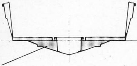
Coques injectées de mousse polyuréthane expansée à forte densité formule sandwich = bateau insubmersible, autovideur, sécurité accrue.
