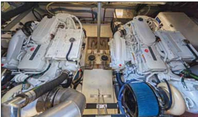
Les deux gros blocs Cummins sont un peu à l'étroit dans cette soute qui s'ouvre depuis le cockpit grâce à une assistance électrique.
