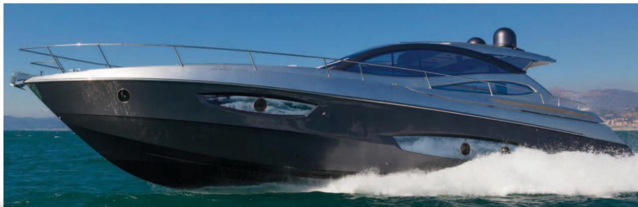
Per portare all'inizio di planata i 18 metri del Granturismo 56 sono sufficienti 9,5 secondi, quando i due motori Cummins entro-bordo da 715 cv arrivano a 1700
