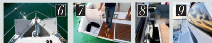
6. Il gavone di prua per verricello elettrico e catena dell'ancora con doppia apertura. 7. I gavoni ricavati nella spiaggia dedicati all'alloggiamento dei parabordi. 8. L'accesso alla sala macchine è un po' stretto, nei prossimi modelli il cantiere prevede uno sportello più ampio. 9. I passavanti laterali sono dotati di antisdrucchio e sono protetti da una battagliola in acciaio.
